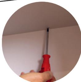
(3) Stellen Sie das Möbel an den vorgesehenen Platz, schieben Sie das Möbel zur Wand, so dass der Bolzen in der Bohrung im Blatt sitzt. Ziehen Sie die Madenschraube innen im Möbel fest. Prüfen Sie die Funktion der Kippsicherung und den festen Sitz aller Schrauben.
