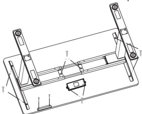
6. Relier le boîtier de contrôle aux deux moteurs et à l'unité de commande. Enfin, raccorder le câble d'alimentation électrique au boîtier de contrôle.
