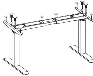
5. Die Tischplatte mit 6 Schrauben 4.8 auf das Tischgestell schrauben und anschliessend die Kontrollbox mit 2 Schrauben 4.8 sowie die Bedienungseinheit mit 2 Schrauben 3.5 unten an der Tischplatte befestigen.
