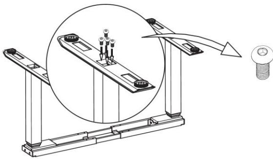
4. Die Tragbügel mit 4 M6x12 Schrauben am Horizontalträger befestigen und die Gummikissen in die dafür vorgesehenen Löcher einsetzen.
