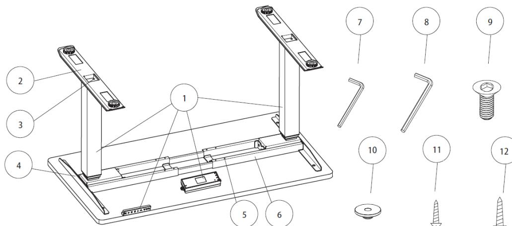
1. Mit dem Inbusschlüssel die Schrauben beim Horizontalträger lösen und die beiden Trägerteile auf die gewünschte Länge / der Tischplatte entsprechend auseinanderziehen. Im Anschluss die Schrauben wieder anziehen.
