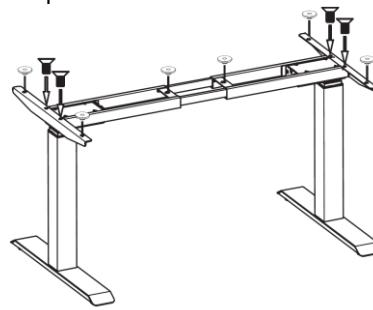
5. Visser le plateau de table sur le cadre de table avec 6 vis 4.8 et fixer ensuite le boîtier de contrôle avec 2 vis 4.8 ainsi que l'unité de commande avec 2 vis 3.5 en bas du plateau de table.
