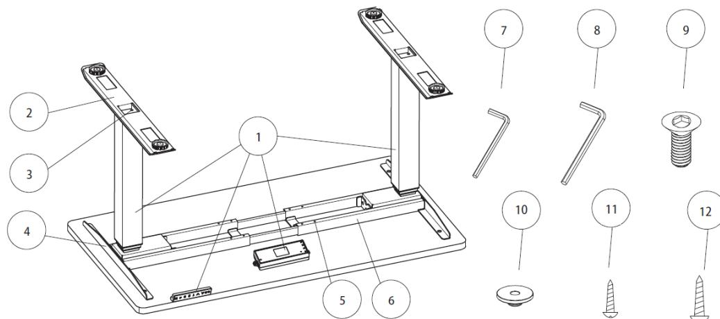
1. Desserrer les vis de la traverse à l'aide de la clé Allen et écarter les deux parties de la traverse à la longueur souhaitée / en fonction du plateau de table. Resserrer ensuite les vis.
