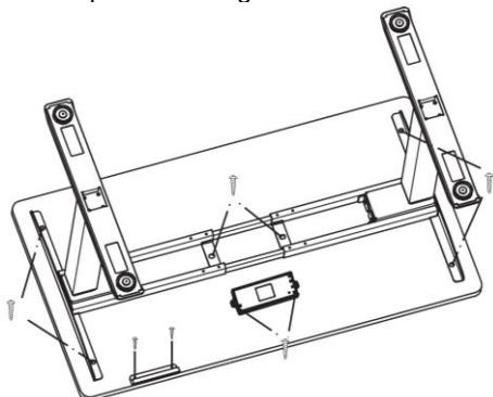
6. Die Kontrollbox mit den beiden Motoren und der Bedienungseinheit verbinden. Zuletzt das Gerätekabel für die Stromversorgung an der Kontrollbox anschliessen.
