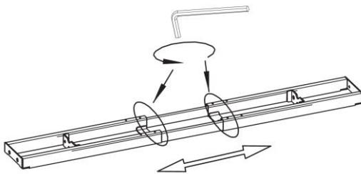
2. Die beiden Tischbeine mit total 8 M6x12 Schrauben am Horizontalträger fixieren.
