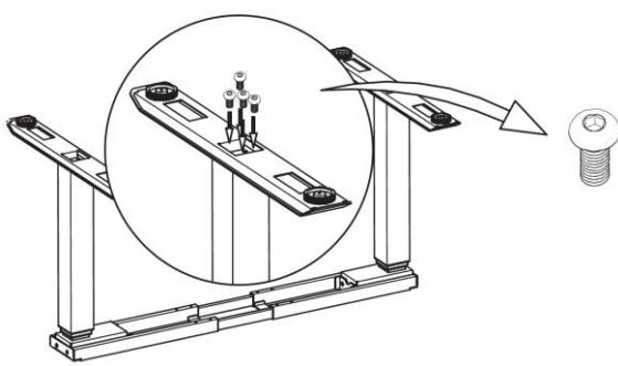
4. Fixer les étriers de support à la poutre horizontale à l'aide de 4 vis M6x12 et placer les coussins en caoutchouc dans les trous prévus à cet effet.
