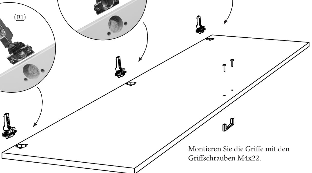
Montieren Sie die Griffe mit den Griffschrauben M4x22.
